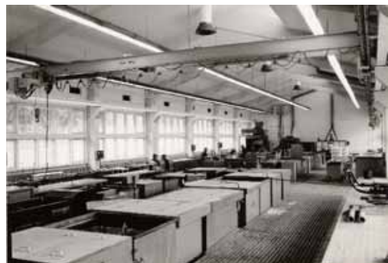
Oberflächen-Werkstatt. Für Unterhaltsarbeiten an Flugzeugen ist eine solche Werkstatt unerlässlich. (Verchromen, Cadmieren, Versilbern etc. von Schwermetallen und Anodisieren von Leichtmetallen).
