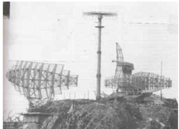
Die Antennen der ersten leistungsfähigen Luft- raum-Überwachungsanlage SFR , sowie eine Peil- antenne.
