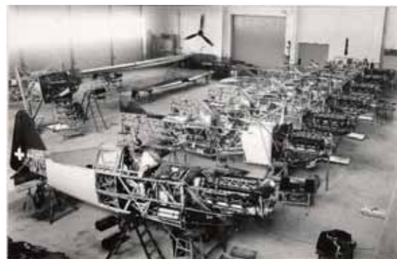
Revisionsarbeiten an Morane D 3800/01.
