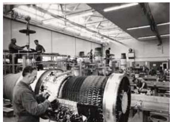
Revisionsarbeiten an Rolls-Royce Avon (Hunter).
